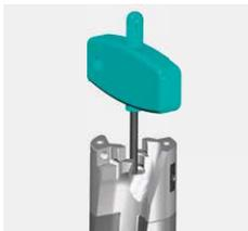
3. Positionner le gabarit de réglage à l'arrière de la tête de perçage démontée.
