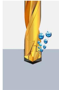
3. Démarrer l'arrosage 2 à 3 secondes avant le début du perçage, régler la vitesse et l'avance nécessaires.
