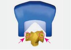
3. Insérer la clé de serrage dans les encoches
