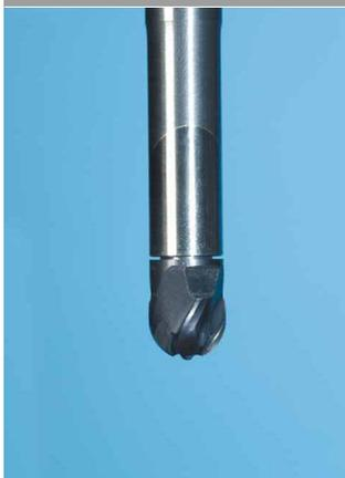
III. 3: Serrage dans l'attachement
