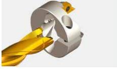
1. Glisser la bague de chanfreinage sur le corps du foret, la butée doit se trouver au niveau de la goujure.
