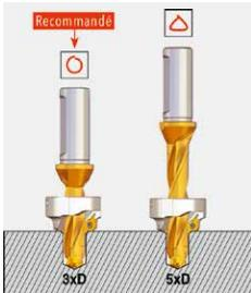
Dans la mesure du possible, toujours utiliser un outil court. Réduire autrement la vitesse de coupe pour minimiser les vibrations.
