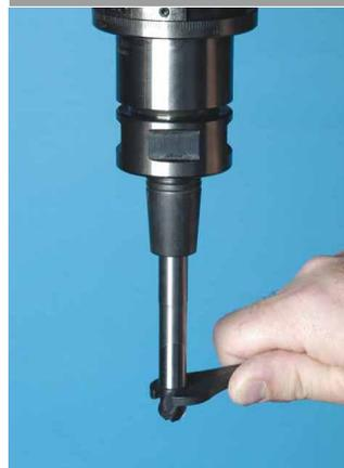
III. 4: La jauge d'épaisseur NE DOIT PAS passer dans la fente de l'interface
