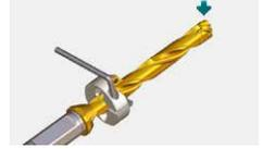
4. Bloquer la bague de chanfreinage et monter l'embout de perçage.
